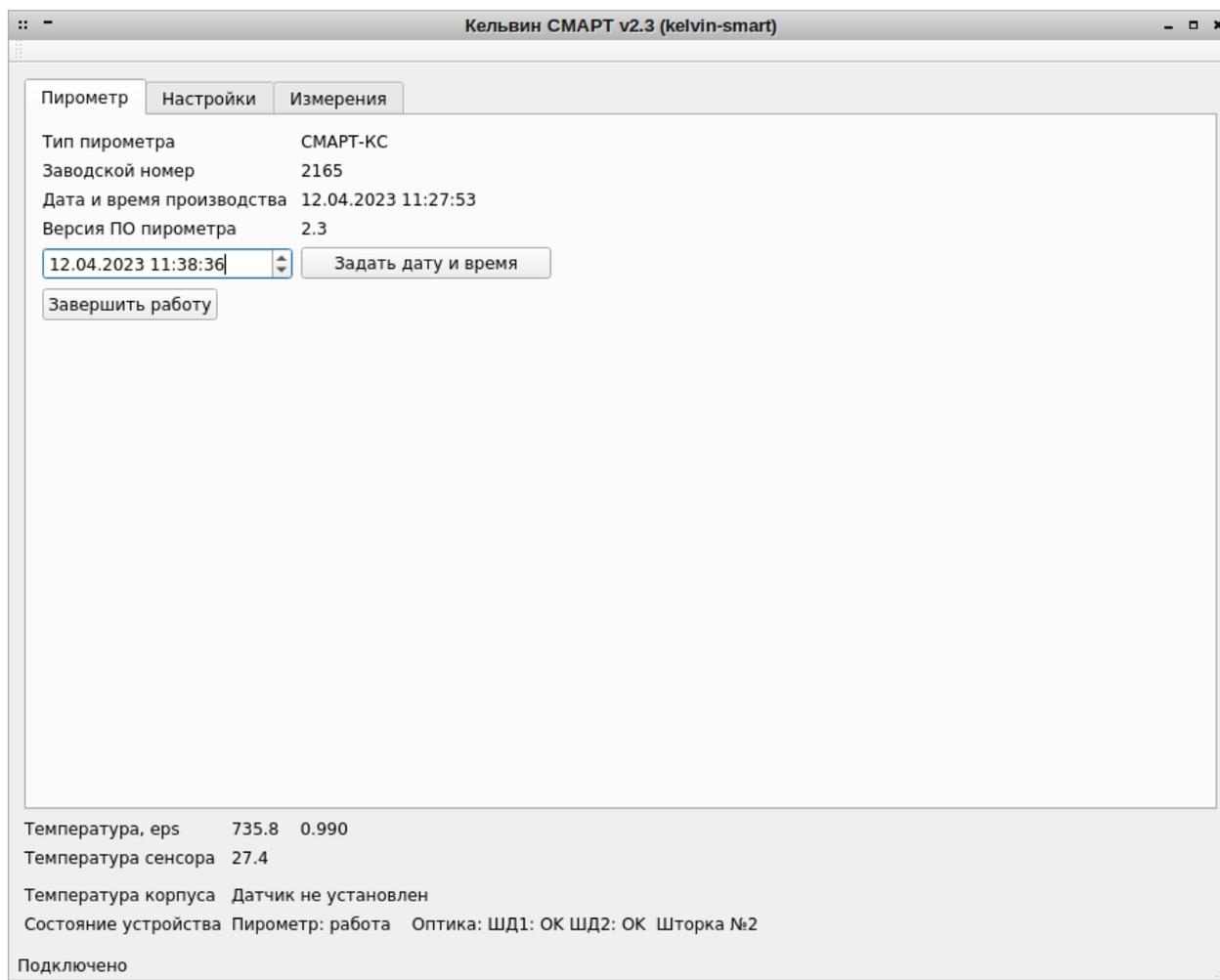
Рисунок 6 – Экран вкладки «Пирометр» программы Кельвин СМАРТ v2.3
