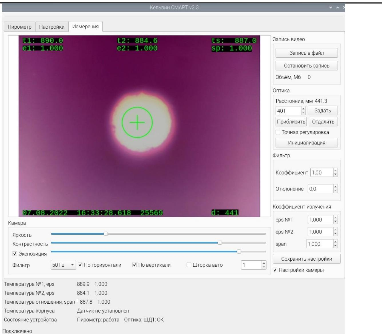
Рисунок 8 – Экран вкладки «Измерения» программы Кельвин СМАРТ v2.3
